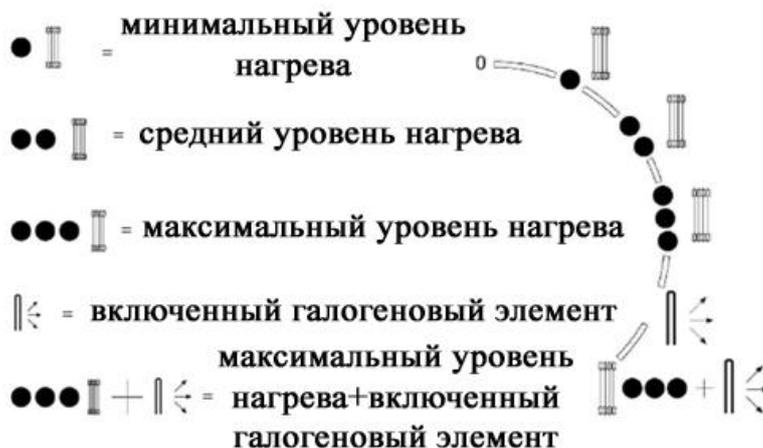
**Внимание!** Если вы установили терморегулятор на максимальный уровень нагрева с включенным галогеновым элементом, когда помещение нагреется до заданной температуры, обогреватель автоматически отключится, но галогеновая лампа будет продолжать греть.
